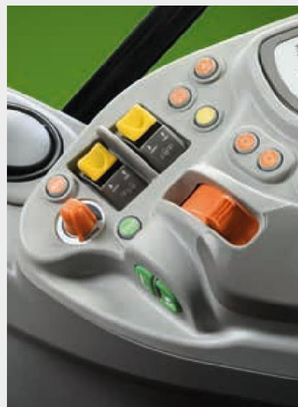
↑ Предно и задно BOM с електрохидравлично задействане и функция AUTO PTO.
