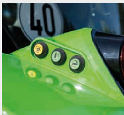
↑ Външен контрол на навес и BOM.
